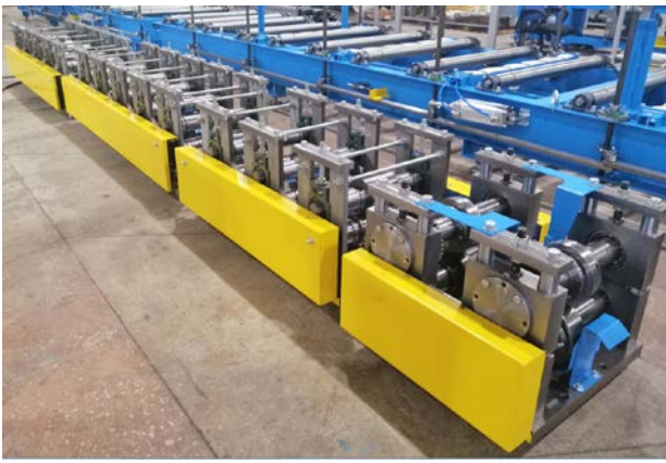
Модульная быстросъемная конструкция профилирующего инструмента / Система управления и гидростанция привод отрезной летучей гильотины.
