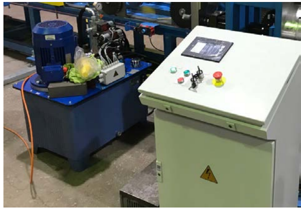
Модульная быстросъемная конструкция профилирующего инструмента / Система управления и гидростанция привод отрезной летучей гильотины.
