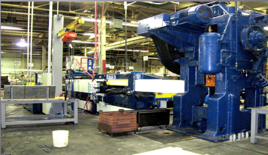
Линия поперечно-клиновой прокатки WRL4012 с горячей штамповкой
