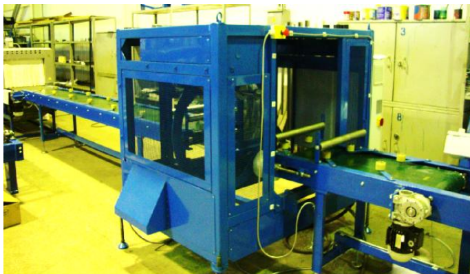
Ленточный транспортер (трубы, желоба)
