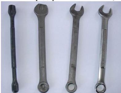
Этапы получения деталей (слева прокатанная деталь, справа окончательное изделие)
