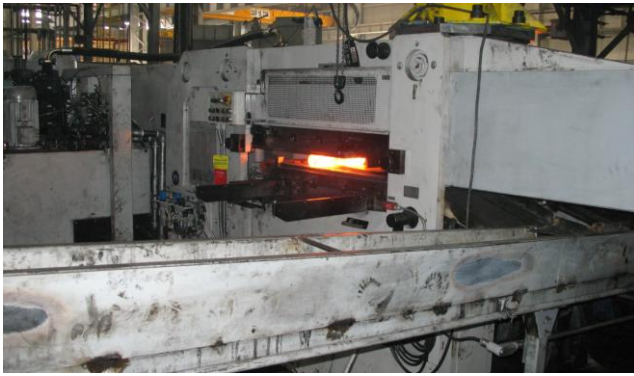
Линия поперечно-клиновой прокатки на производстве
